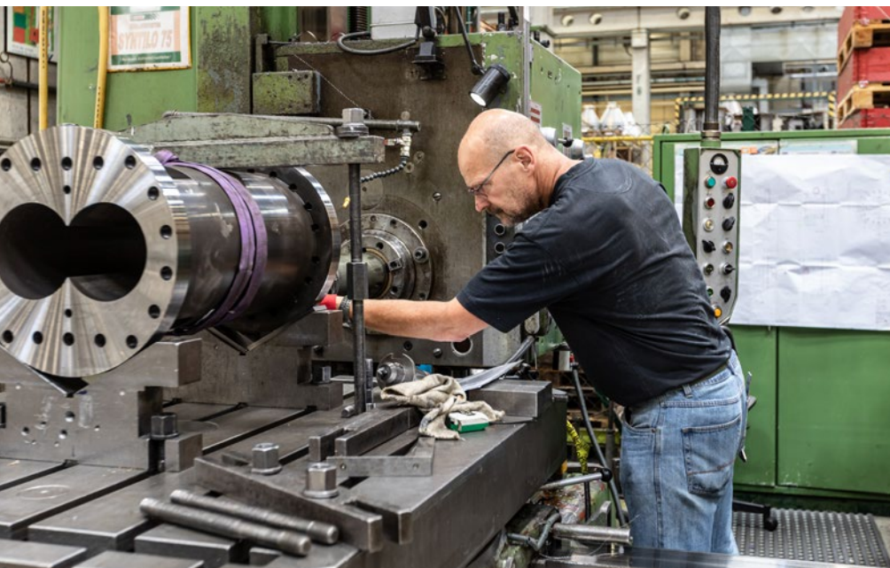
Auf dem Bohrwerk wird eine Indexbohrung eines Zylindersegments ausgespindelt.
