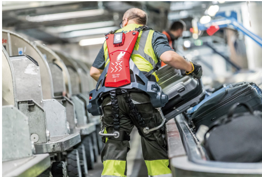
Ein Exoskelett unterstützt einen Arbeiter am Flughafen beim Heben und Tragen von Gepäck.
