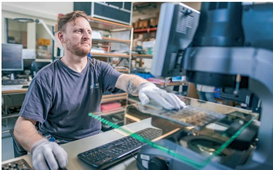
Mithilfe eines Mikroskops werden die Leiterplatten auf Schadhaftigkeit geprüft.
