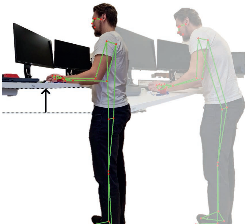
Beim Abraka-Assembly-Tisch stellt eine künstliche Intelligenz die optimale Arbeitshöhe ein.
