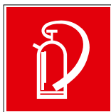
Hinweis auf ein Feuerlöschgerät
